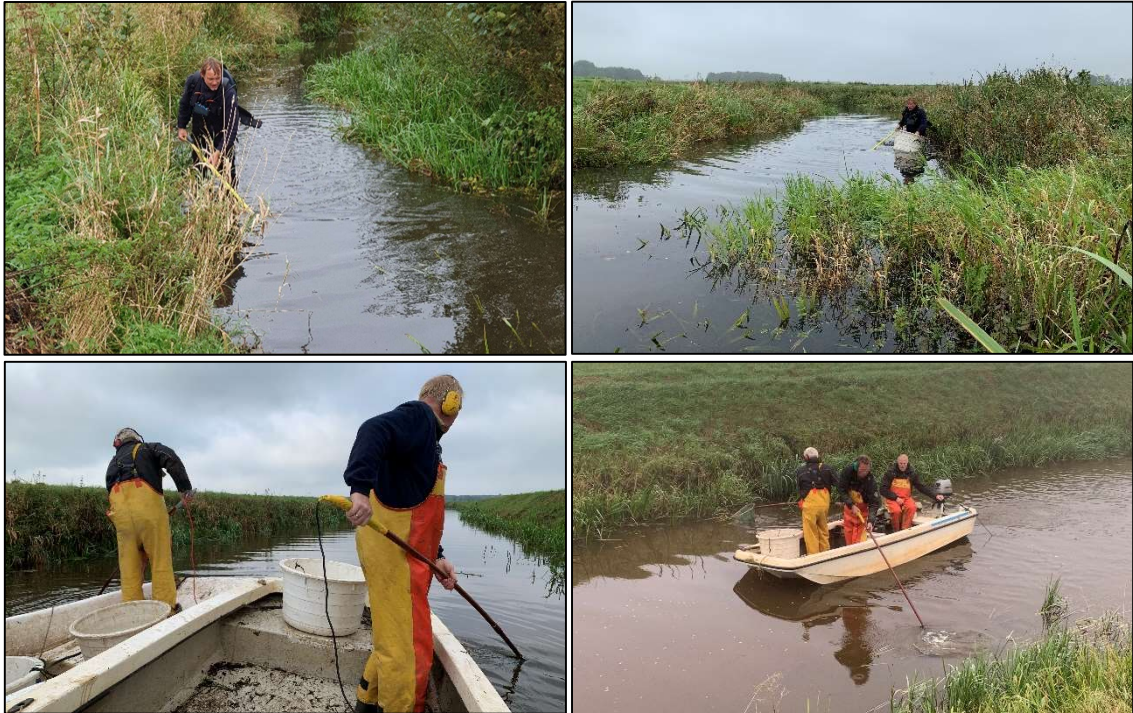
figuur 2.3 Electrovisserij wadend met een draagbaar elektrovisapparaat en een schepnet (boven), vanuit één boot op smalle trajecten (rechtsonder) en elektrovisserij op brede trajecten vanuit twee boten (linksonder).
